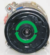
náboj (ne řemenice) se může točit oběma směry
